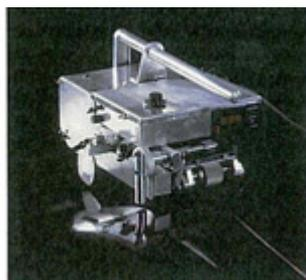
熱空氣焊接是以熱空氣焊接機在接縫重疊處加熱，使其熱力透過不透水布進入重疊層，再藉著滾輪滾壓形成同一材質之結合物。自動焊接機同時焊接了二道接縫是加強接縫處抗拉強度，是最簡單、最快捷、最新焊接技術。
